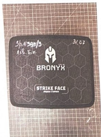
Фото зразка № 395/3.1 до випробувань
