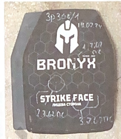
Фото зразка № 368/1 після випробувань
